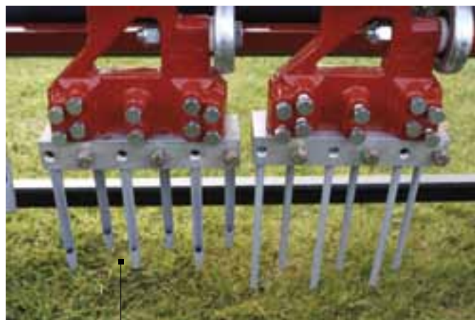
Tyde hugpiber (tv) og massive spyd (th) monteret på allublokke for behandling med lille afstand.
