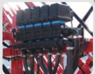
IT Distributori acqua elettrici
